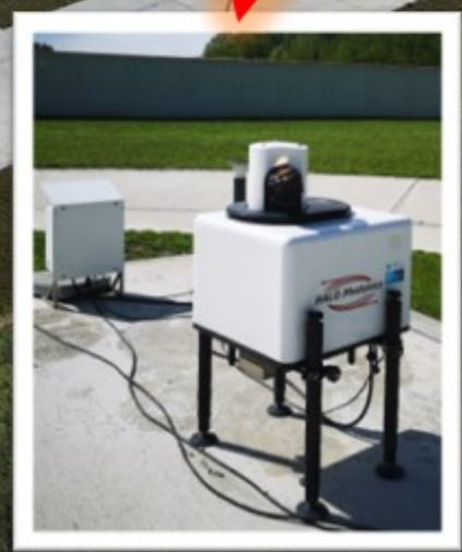
Doppler wind lidar
