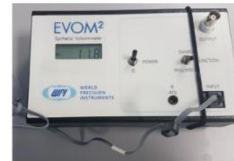
Voltohmmetru folosit pentru evaluarea rezistenței electrice trans-epiteliale
